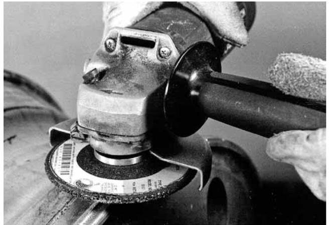
*Utilizada con un disco para lijar, un disco de corte o un esmeril, esta es una versión de esmeriladora eléctrica. Esta herramienta es también muy rápida y efectiva, y debe tenerse cuidado de eliminar el metal lo más uniformemente posible y no mellar la llanta.*
