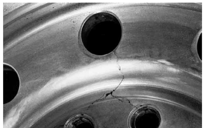
A la derecha se muestran fracturas que parten de orificio roscado a orificio roscado. Las causas son: diámetro insuficiente de superficie de soporte de llanta, superficie de soporte no plana, partes de conexión incorrectas (ver sección 5.c.) y par de apriete insuficiente (ver secciones 5.n.ii. y 5.n.iii.). Ponga la llanta fuera de servicio.
