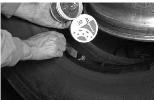
Aplique también ALgrease a los dos talones del neumático. Proceda a montar el neumático según los procedimientos de montaje y las directrices de seguridad provistas por los fabricantes del neumático.
