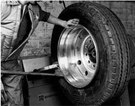
Quite el vástago de la válvula para asegurarse de un desinflado completo. Coloque la llanta en la máquina e inserte la herramienta de modo que la parte plana se pueda manejar entre el talón del neumático y el borde del borde de la llanta. Mueva la herramienta hacia su posición vertical hasta que el talón se separe de la llanta.
