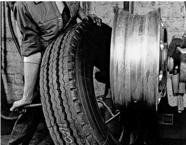
Inserte el final curvo de la herramienta entre el talón y el borde de la llanta con un tope contra el borde. Mediante pequeños movimientos circulares, utilice breves empujes sucesivos para montar el talón sobre el borde. Presione la herramienta hacia abajo a medida que el talón se va asentando sobre el reborde.
