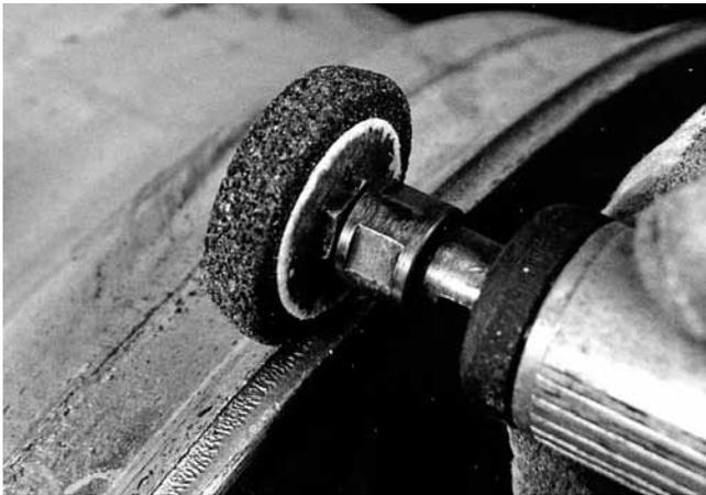
*Otro método rápido y efectivo para eliminar el canto afilado causado por el desgaste de la ceja del borde de la llanta. Tenga cuidado ya que el esmeril puede taparse con las rebabas de aluminio. Tenga cuidado de no mellar la llanta.*
