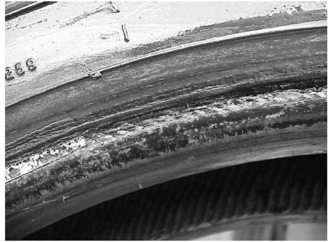
Inspeccione todos los componentes finales del eje para ver si muestran signos de exposición a un calor excesivo. Preste atención particular a los discos o tambores de freno. Si uno de estos componentes muestra signos de sobrecalentamiento, todo el ensamblaje, incluyendo la llanta, se deberá sustituir.
