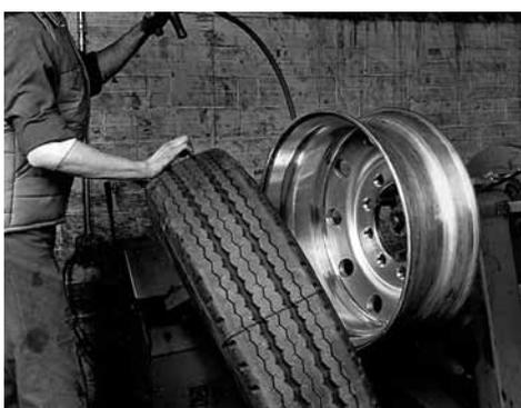
Inserte en línea recta el final de la herramienta de neumático entre los talones y los dos bordes del borde de la llanta, apoyando el tope en la herramienta sobre un segundo borde. Coloque la herramienta a 90° con respecto al ensamblaje de neumático en la parte superior de la llanta y lubrique las áreas de talón a ambos lados de la herramienta. Inclíne el ensamblaje de neumático hacia la herramienta y sacúdala hasta despegarla del neumático.
