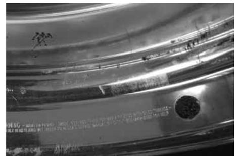
Si alguna de estas etiquetas redondas muestra signos de burbujas, carbonización, ennegrecimiento o agrietamiento, esto podría indicar que la llanta se ha expuesto a un calor excesivo.
