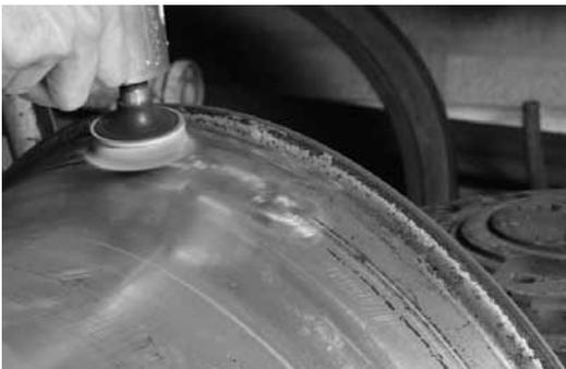
Antes de montar un nuevo neumático limpie los asientos de talón en profundidad con un cepillo de alambres o una herramienta de potencia apropiada hasta que se consiga una superficie suave y limpia. Evite utilizar herramientas abrasivas fuertes y/o una fuerza expresiva que pudiese romper o abollar la superficie. Una superficie irregular o dañada puede provocar fugas.
