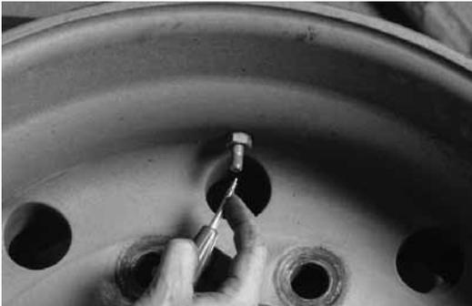
Retire el vástago de válvulas al limpiar los asientos de talón para evitar la acumulación de suciedad en el tubo de la válvula, lo que podría ocasionar un mal funcionamiento de la válvula.
