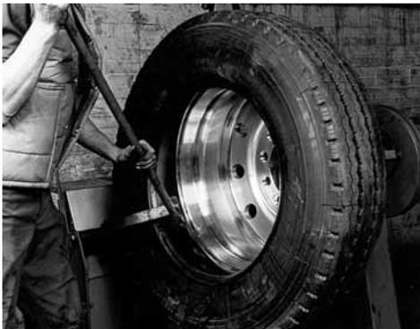
Repita el procedimiento hasta que todo el talón se separe de la llanta. Siga el mismo procedimiento con el otro lado de la llanta. Ahora se puede desmontar el neumático. Lubrique el talón del neumático.
