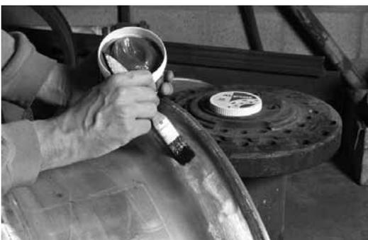
Aplique una película de ALgrease a ambos asientos de talón, bordes de borde de la llanta, protuberancias y lados curvados del alojamiento de borde de la llanta.
