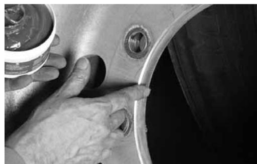
ALgrease se puede utilizar con seguridad sobre aluminio y acero. Resiste altas y bajas temperaturas. Las partes y las superficies tratadas con ALgrease están protegidas ante la corrosión. Se recomienda utilizar ALgrease cada vez que se monten las llantas.
